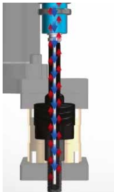
Funktion Kernkühlung Beispiel Gewindeausschraubeinheit
